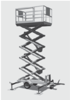
Statisch Vertikal (1a): Senkrecht-Hubarbeitsbühnen auf Stützen
