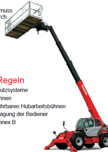
4 Multifunktionsgerät mit schwenkbarem Arbeitskorb und geeigneten Zustiegtüren.
